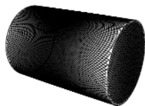
Pokrycie powierzchni po pełnym cyklu mycia
