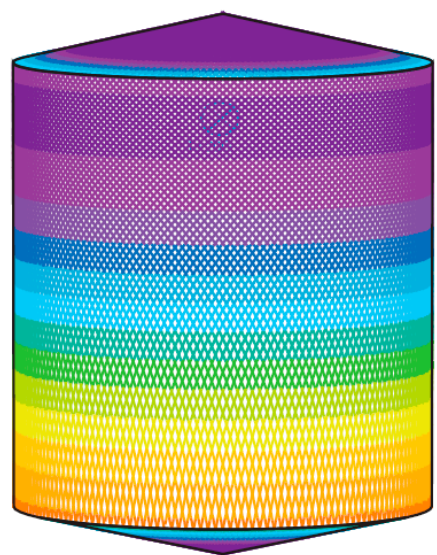
D4.6m H5.5m, Toftejorg TJ40G, 4 x ø7.3mm, Czas = 16 min, Zużycie wody = 5600 l
